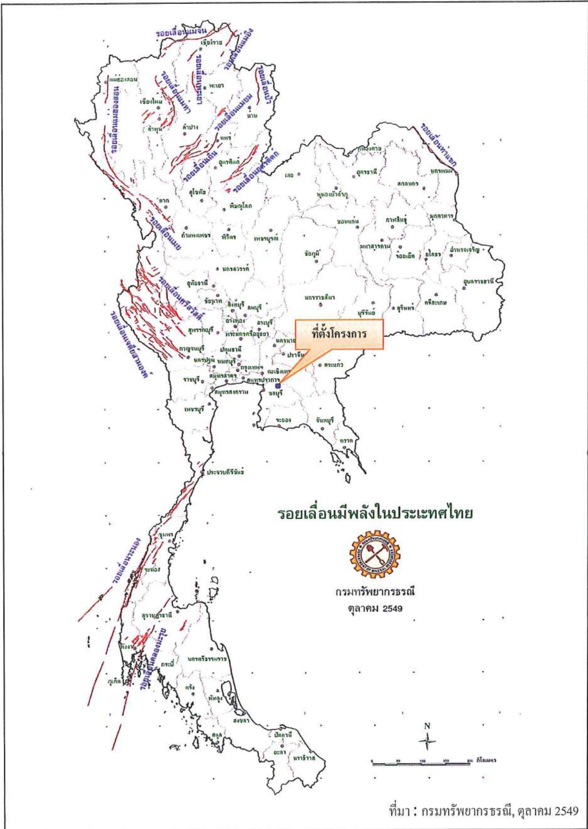
รูปที่ 4.2.2-2 แผนที่รอยเลื่อนมีพลังในประเทศไทย
